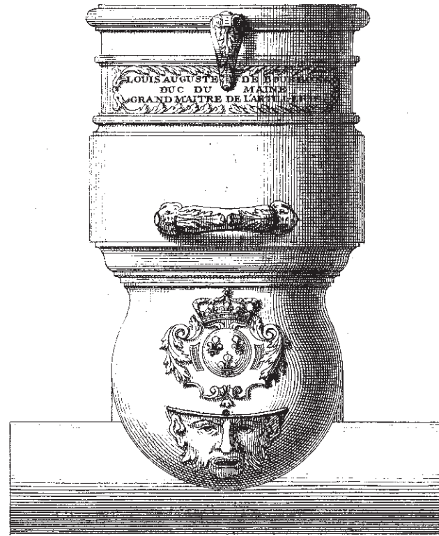
Mortier de 12 pouces de calibre, à chambre poire, contenant 12 livres de poudre.
